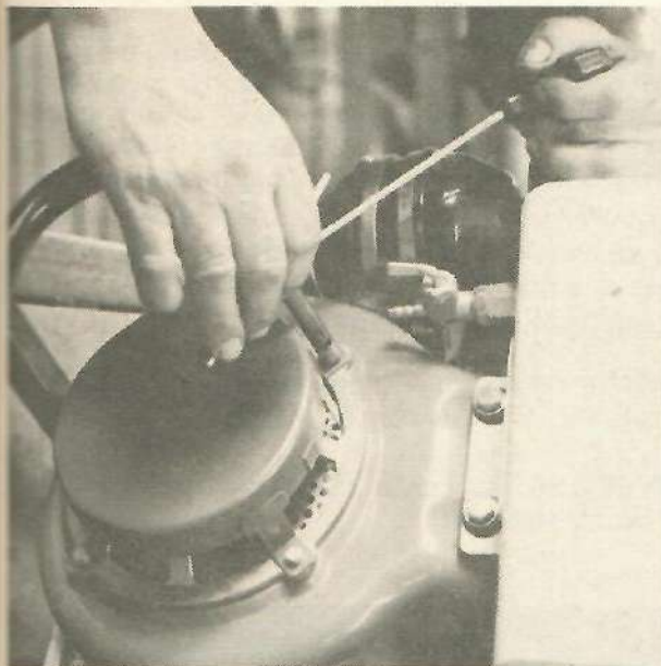
25. ÁBRA Az indítószerkezet központosítása
