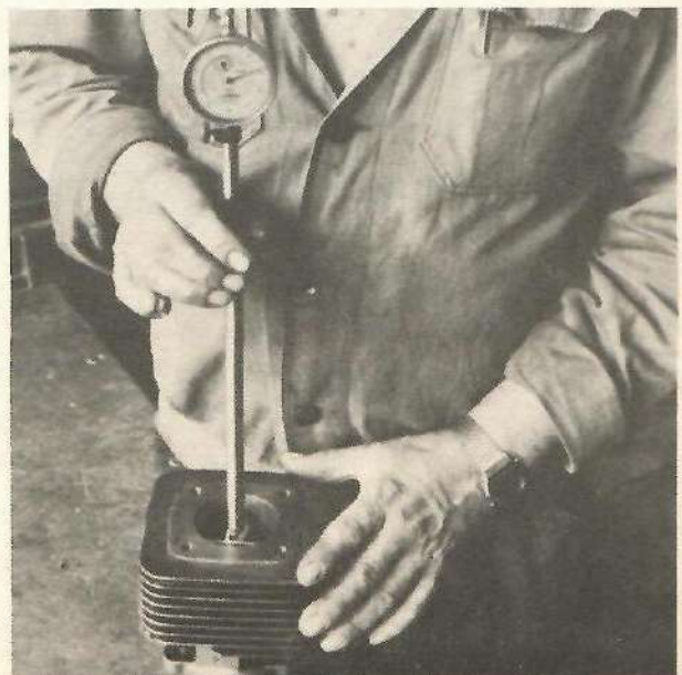
33. ÁBRA A hengerfurat kopásának mérése
