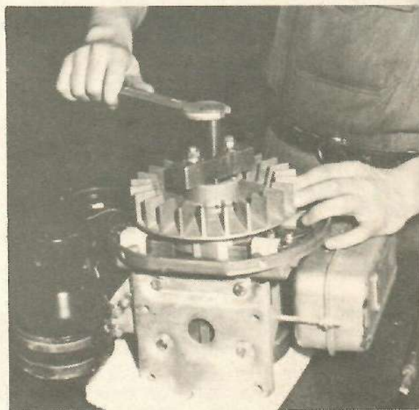
28. ÁBRA A ventilátor leszerelése
