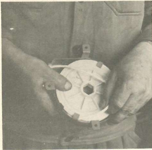
21. ÁBRA Az indító szerkezet lemezugójának felhúzása
