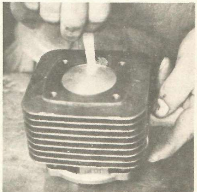
35. ÁBRA A dugattyújáték mérése
