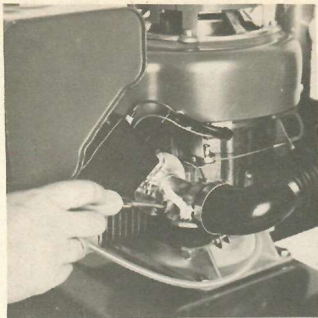
27/a. ÁBRA A karburátor beszbályozása (alápjázat állító csavar)
