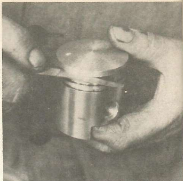
38. ÁBRA A gyűrű oldaljáték mérése
