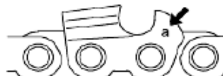
A láncosztás (a) be van jelölve minden egyes vágószem mélységhatárolóján.
